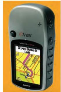
**Navegação** - fornecem o posicionamento em tempo real (código C/A) e trabalham com pseudodistâncias obtendo-se precisão da ordem de 10 a 20 metros. Existem opções com DGPS - semelhantes aos GPS de navegação, porém possuem um link de rádio, utilizado para receber as correções diferenciais provenientes de uma estação base. Através dessas correções em tempo real, consegue-se eliminar o maior erro do GPS que é o AS, obtendo-se precisão da ordem de 1 a 3 metros.
